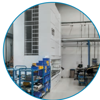
Entrepôts automatisés et système de codes à barres pour une traçabilité totale des matériaux
